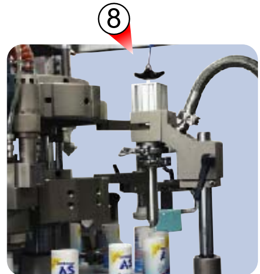
INIETTORE DISCENDENTE A CORSA REGOLABILE DI 130 mm
